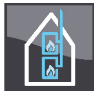
Decentrale varmeanlæg tilsluttet samme skorsten (gasvandvarmere o.l.)
