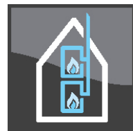
Decentrale varmeanlæg tilsluttet samme skorsten (gasvandvarmere o.l.)
