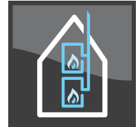
Gasfeuerstätten an mehrfachbelegten Schornsteinen
