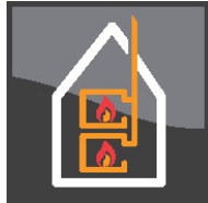
Holzfeuerstätten an mehrfachbelegten Schornsteinen
