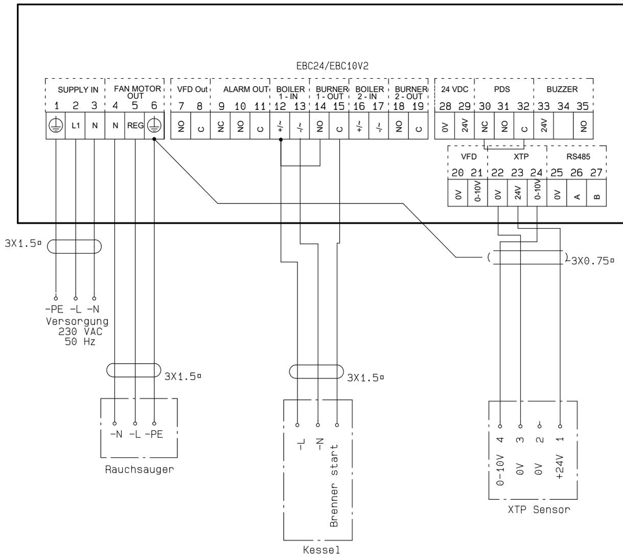
Dieses Beispiel zeigt, wie ein Spannungssignal (18-230 V AC / DC) an EBC10v2 angeschlossen wird, um den Rauchsauger zu starten / zu stoppen.
